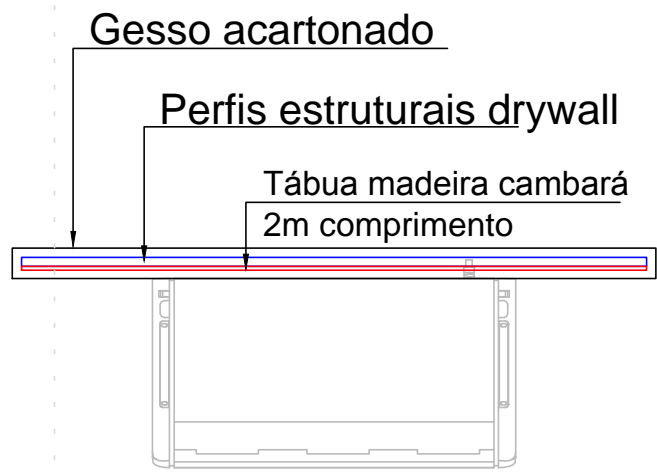
FIXAÇÃO ARCONDICIONADO NO DRYWALL Esc: 1/25
